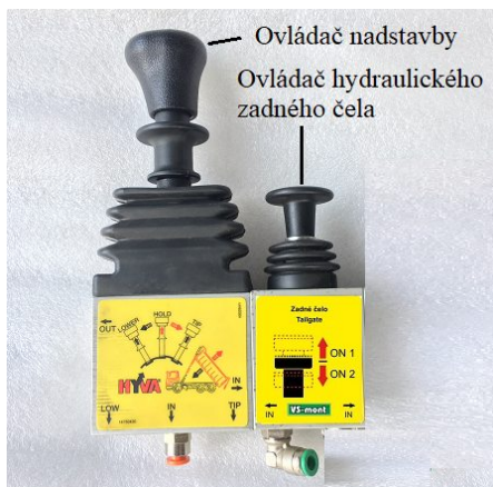
Obr. 2 /Ovládání hydr. zadního čela/ /Zdvih a klesání nadstavby/
